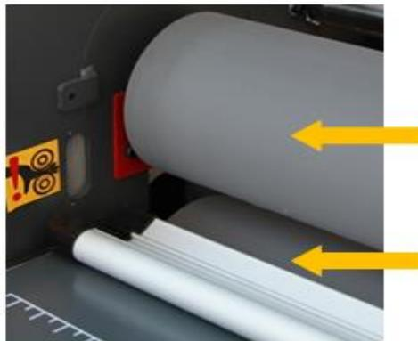
Ober- und Unterwalzen sind die Schlüsselkomponente des Laminators und wirken sich direkt auf die Qualität der Laminierung aus. Achten Sie darauf, dass sie nicht durch scharfes Werkzeug beim Laminieren zerkratzt werden. Die beiden Walzen bestehen aus Silikon. Der Vorteil ist eine gute Wärme-, Säure- und Alkalibeständigkeit. Verhindern Sie das Anhaften an kalten Laminierfolien. Die Unterwalze wird motorisch gesteuert, die Oberwalze durch Reibung gedreht.
