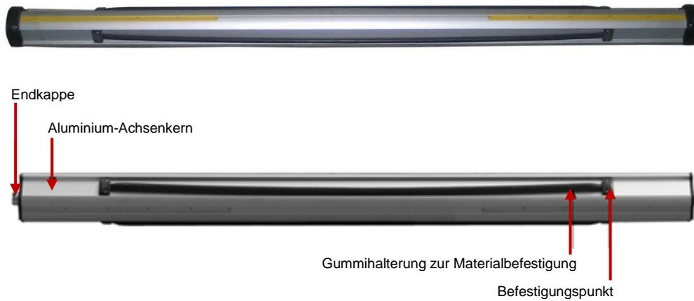
Sie können die Trägerachsen aus dem Laminator nehmen, indem Sie deren Verriegelungsring so lange drehen bis Sie die jeweilige Achse herausheben können. Beim Wiedereinsetzen ist darauf zu achten, dass die Nut in der Endkappe passgenau auf den Stift in der Halterung gesetzt wird.
