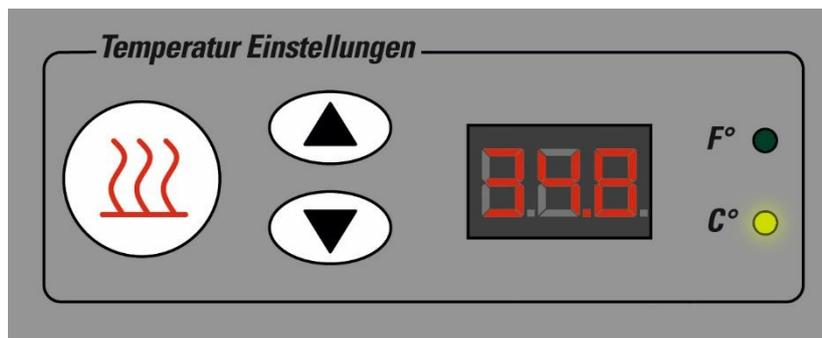
Die Walzentemperatur wird über die Heiztaste geregelt. Das Display zeigt die Walzentemperatur an.
