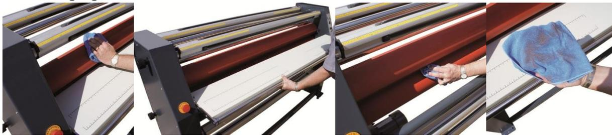
Benutzen Sie zur Reinigung das mit Wasser angefeuchtete Spezialreinigungstuch. Verwenden Sie zur Reinigung weder organische Lösungsmittel, noch Verdüner, Benzol, Ethanol/Spiritus oder andere scharfe Reinigungsmittel. Benutzen Sie keine harten und scharfen Werkzeuge wie Messer, Schraubenzieher etc. zur Reinigung, um Kratzer auf der Walze zu vermeiden.
