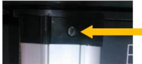
Heben Sie die Andruckschiene an und nehmen Sie sie ab. Setzen Sie die Schraube in die Löcher der Andruckschiene ein, um sie wieder einzusetzen.
