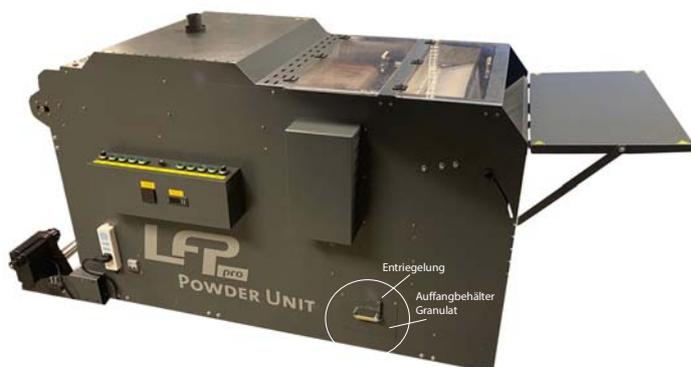
Dieses ungenutzte Granulat kann natürlich wiederverwendet werden. Öffnen Sie dafür die Entriegelung, entnehmen Sie den Auffangbehälter und füllen Sie das Granulat wieder in den Vorratsbehälter. Danach den Auffangbehälter wieder einsetzen und den Riegel umlegen. Jetzt kann das überschüssige Granulat wieder gesammelt werden!
